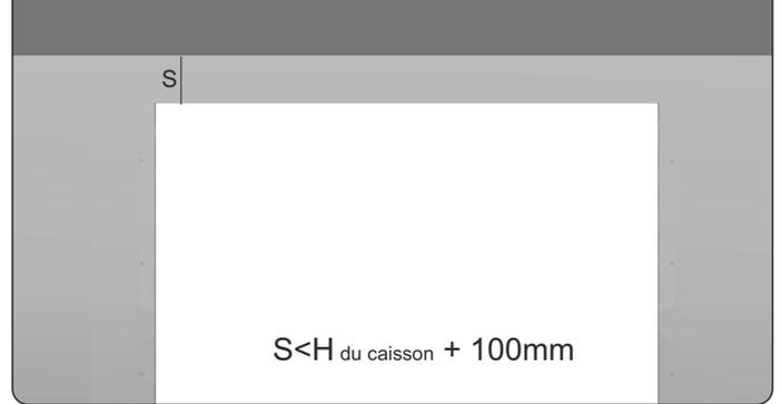
9a. Si la hauteur S est inférieure à la H du caisson +100mm, le caisson de la porte doit être montée apposée sur les coulisses (fournies dans le kit).
