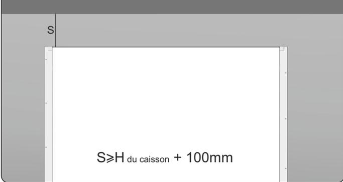
9. La hauteur minimale S nécessaire au montage du caisson de la porte avec les coulisses fixées est calculée en ajoutant 100mm à la hauteur du caisson.
